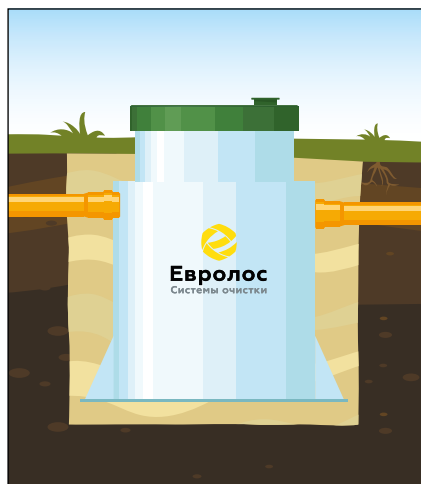
«Евролос ПРО» — стандартный подвод коллектора на глубине до 0,6 м по низу трубы.
